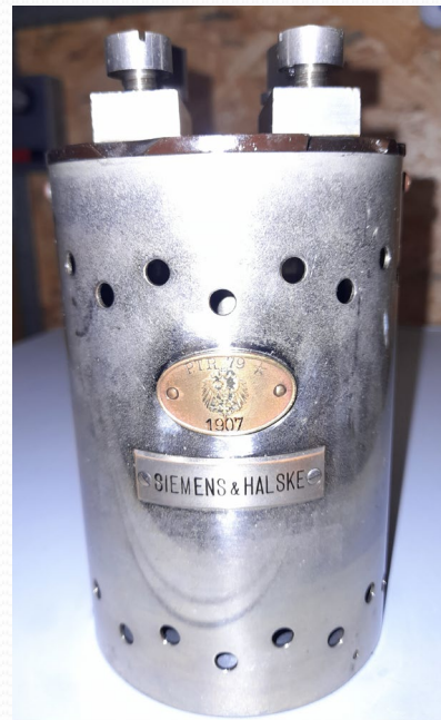
Resistor patrón 1 \Omega (1907) (UTE)
